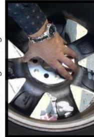
**9** Auch an der Achse muss die Distanzscheibe vollflächig anliegen.
